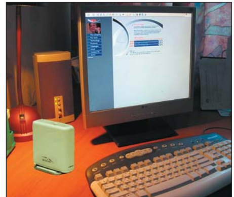
Рис. 5. Комнатная шестилучевая антенна диапазона 3,5 ГГц с автопоиском наилучшего направления внутри помещения в условиях отсутствия прямой видимости базовой станции
