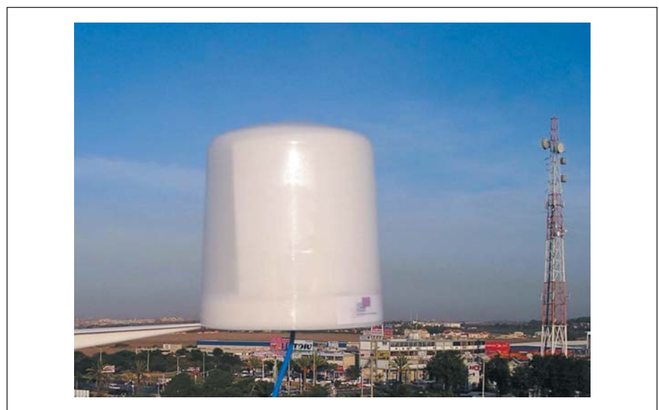
Рис. 6. Наружная восьмилучевая антенна абонентского терминала, работающая в диапазоне 3,5 ГГц, с режимом автопоиска базовой станции
