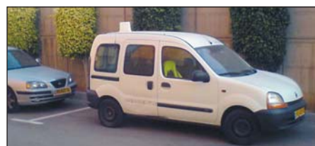
Рис. 7. Шестилучевая наружная следящая антенна, установленная на легковом автомобиле. Диапазон частот — 2,3 ГГц
