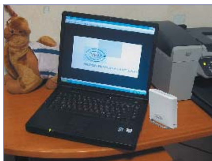
Рис. 4. Комнатная шестилучевая антенна диапазона 3,5 ГГц с автопоиском наилучшего направления внутри помещения в условиях отсутствия прямой видимости
