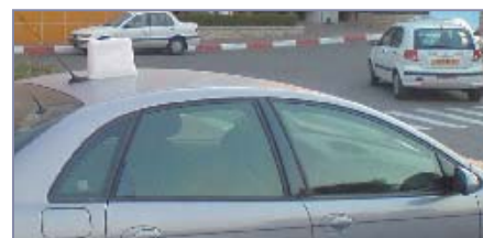
Рис. 5. Шестилучевая наружная следящая антенна, установленная на легковом автомобиле. Диапазон частот 2,3 ГГц
