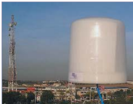
Рис. 3. Наружная восьмилучевая антенна абонентского терминала фиксированной связи в диапазоне 3,5 ГГц с режимом самоинсталляции
